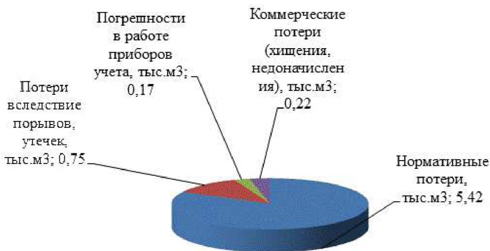
Рисунок 8 – Структурные составляющих потерь питьевой воды при ее производстве и транспортировке
